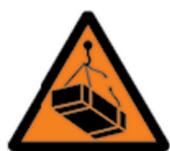
Attention requise en cas de levage d'un poids en hauteur. Ne levez jamais de charge lourde en utilisant uniquement la force physique d'une personne. Consultez les règles nationales et/ou internationales applicables. Une tension physique excessive ou le fait de se tenir sous la/les charge(s) pourrait causer des blessures physiques ou la mort.
