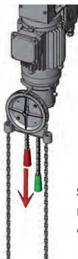
Se non occorrono ulteriori interventi manuali tirare la leva rossa per bloccare l'azione della catena manuale di emergenza e riavviare il motore.
