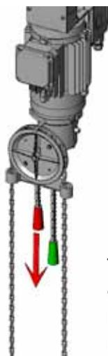
Tirer sur la manette rouge pour interrompre l'actionnement de la chaîne de manœuvre d'urgence, puis allumer de nouveau le moteur, si l'actionnement manuel n'est plus requis.
